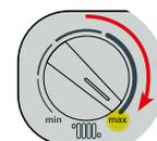
Bei aktivierter Kalibrierfunktion der Verbrennung kann der Knopf für die Temperatureinstellung des Heizwassers nicht für die Änderung der Kesselleistung (Ventilator Drehzahl) genutzt werden, wie bei der Funktion Schornsteinfeger.
