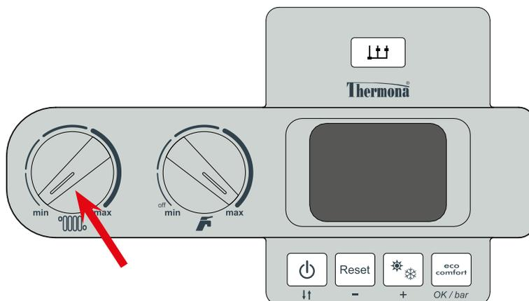
**Bei einer aktivierten äquithermischen Regelung ändert sich die Bedeutung der Funktion des mittleren Drehreglers am Bedienfeld des Kessels. Mit dem gekennzeichneten Drehregler wird in diesem Fall die Verschiebung der Heizkurve eingestellt (im Umfang  $\pm 15\text{ }^{\circ}\text{C}$  der vom Servicetechniker eingestellten Äquithermkurve).**
