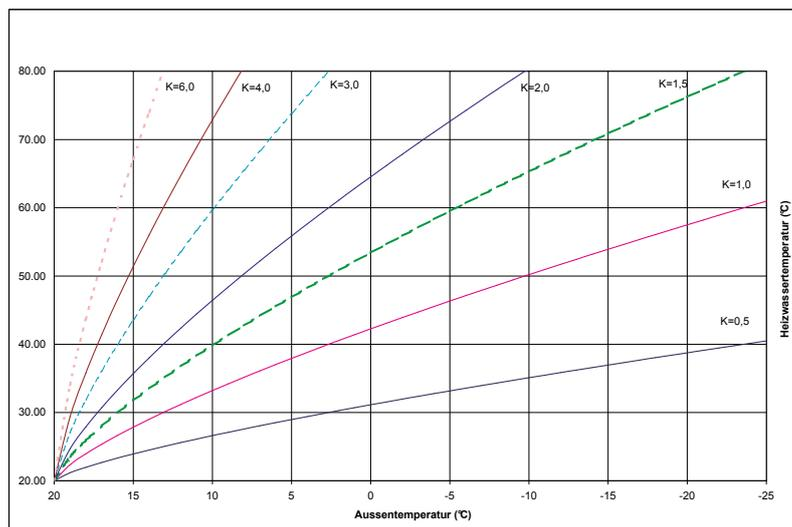
Die berechnete Temperatur des Heizwassers ist auf maximal 80 °C begrenzt. Falls sich die berechnete Temperatur im Bereich von 20 ÷ 35 °C bewegt, wird die gewünschte Temperatur auf die minimale Kesseltemperatur, d.h. 30 °C begrenzt und es wird die Funktion des periodischen Starten des Kessels in einem festen Intervall von 15 Minuten und einer festen Laufzeit auf 30 °C nach der Beziehung gestartet:
