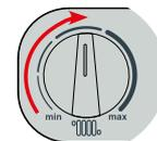
Zum Schluss drehen wir den Knopf für die Temperatureinstellung des Heizwassers in die Maximalstellung – der Kessel erhöht nach und nach die Leistung auf den Maximalwert und anschließend erscheint auf dem Display „P2“. Die Steuerung ist für die Durchführung der Korrektur der CO<sub>2</sub>-Einstellung bei Maximalleistung vorbereitet. Die Korrektur erfolgt mittels der Tasten 2 (Reduzierung des CO<sub>2</sub>-Werts) und 3 (Erhöhung des CO<sub>2</sub>-Werts)
