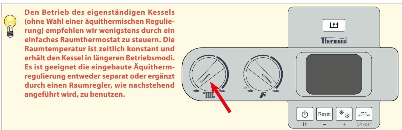
**Den Betrieb des eigenständigen Kessels (ohne Wahl einer äquithermischen Regulierung) empfehlen wir wenigstens durch ein einfaches Raumthermostat zu steuern. Die Raumtemperatur ist zeitlich konstant und erhält den Kessel in längeren Betriebsmodi. Es ist geeignet die eingebaute Äquithermregulierung entweder separat oder ergänzt durch einen Raumregler, wie nachstehend angeführt wird, zu benutzen.**
